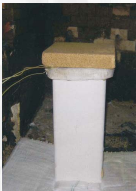
Конструкция, покрашенная Steelmaster
