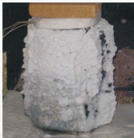
Конструкция после проведения пожарного испытания
